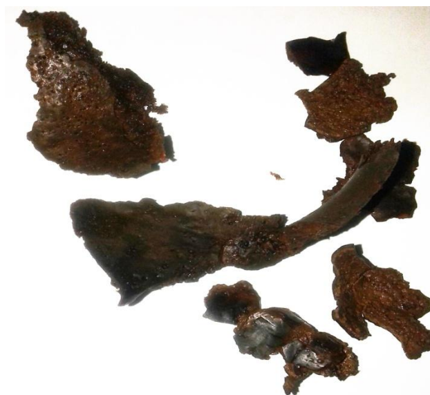
FIGURA 1 - Incrustação do esterilizador Rossi & Catelli após dois ciclos de 30 horas de produção, com um clean in place intermediário entre os ciclos.
